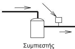
Θέση του διακόπτη υψηλής πίεσης
